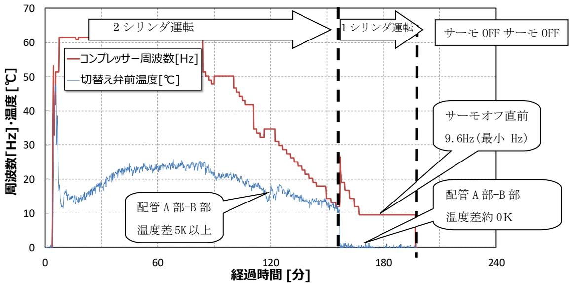
図 5： 暖房運転時の実機確認例
