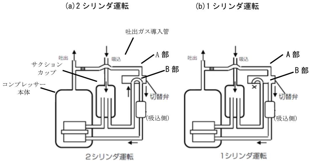
図2：シリンダ運転切替動作の概要
