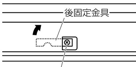
ねじを右に回してワークトップに確実に固定する
