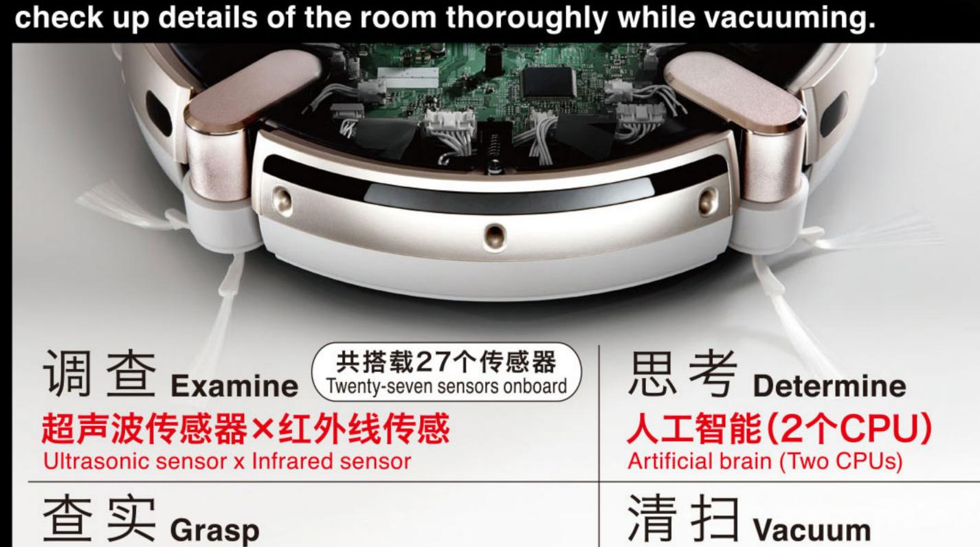
红外线距离(PSD)传感器 Infrared distance (PSD) sensor
