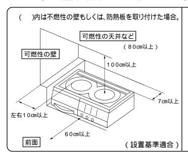
可燃性の壁より、左記の距離を離して据付できない場合は、防火上有効な防熱処理をしてください。
