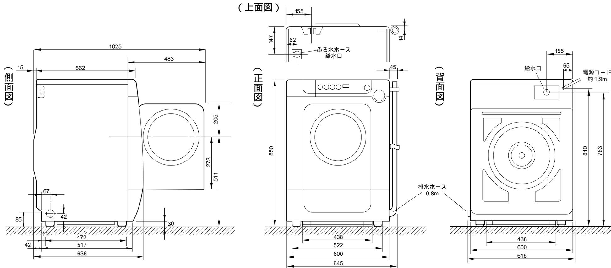
1 設置の際、本体からの隔離寸法は、左右20mm以上、上部10mm以上、後方10mm以上です。
